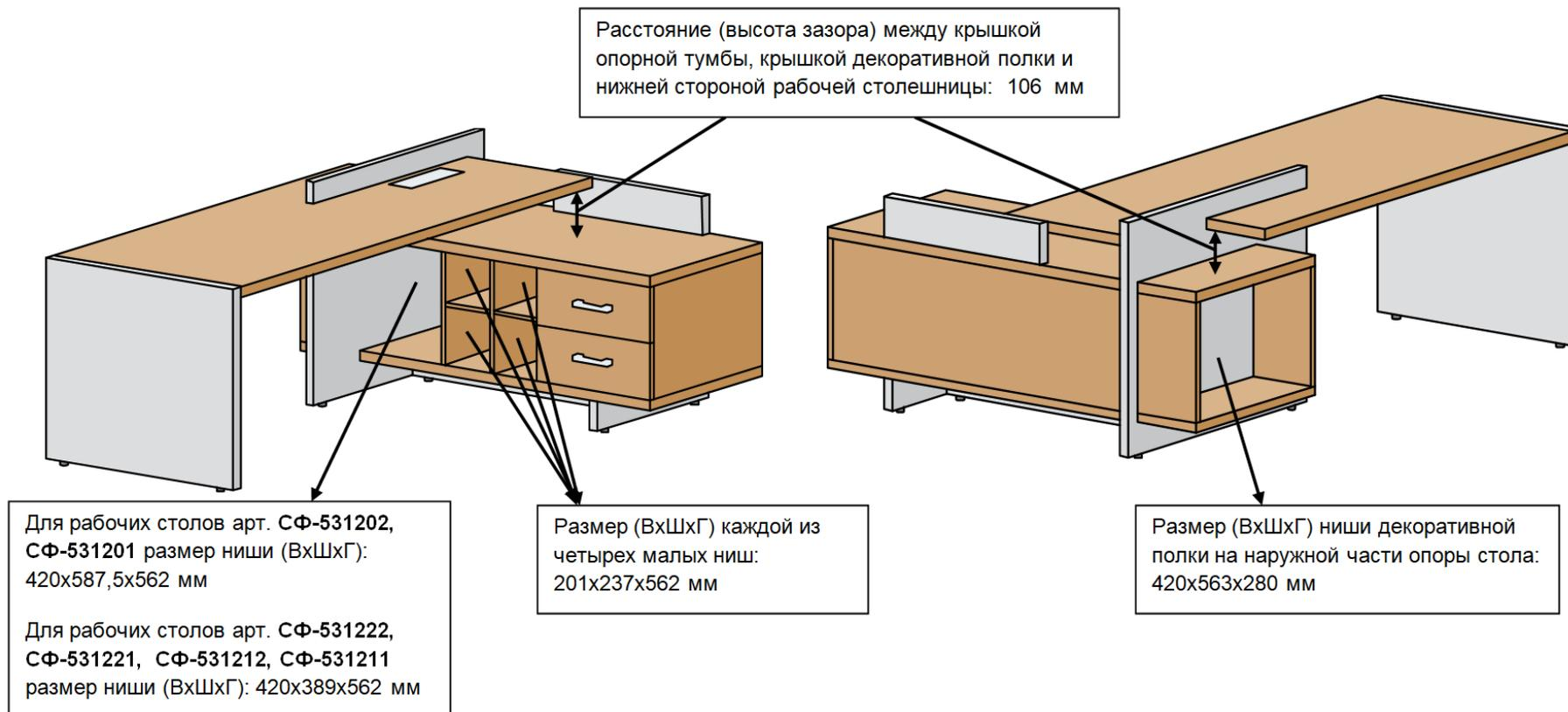
В опорной тумбе размещены также два выдвижных ящика на скрытых шариковых направляющих полного выдвижения с доводчиком; два разъемных проводника из серебристого пластика для подвода проводов от уровня пола. Эти проводники
