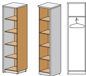
В древодекоре из плиты ДСП толщиной 18 мм изготавливаются: полки, задняя стенка и одна боковая стенка.
