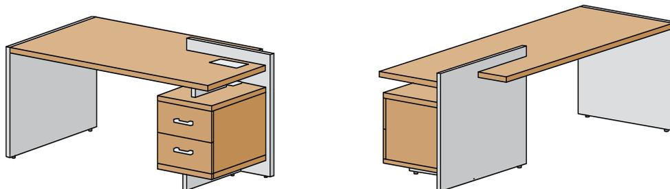
Основные конструктивные элементы, материалы и комплектующие прямых рабочих столов аналогичны применяемым в угловых рабочих столах. Отличие состоит в опорной тумбе, которая, при сравнении с тумбой углового стола: развернута фасадами вдоль длины стола, не содержит внешние и внутренние открытые ниши, не выступает за габариты стола, в выдвижных ящиках отсутствуют разделители/перегородки.
