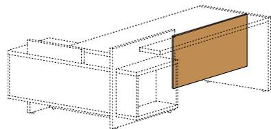
Рабочие столы могут оснащаться нижним экраном. Поставляется отдельно. Изготавливается из ДСП 18 мм в древодекоре в **четырёх** вариантах длины, в зависимости от длины рабочего стола. Устанавливается под столешницей между опорами стола. Универсальное исполнение – для левого и правого варианта, **угловых и прямых** рабочих столов.
