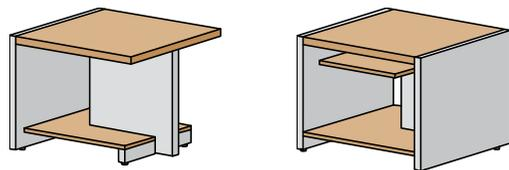
В древодекоре изготавливается столешница - толщиной 38 мм; полки и царги классического стола – толщиной 18 мм.
